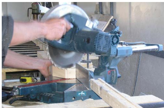
40. ábra Pallóvégek leszabása a csomóponthoz
