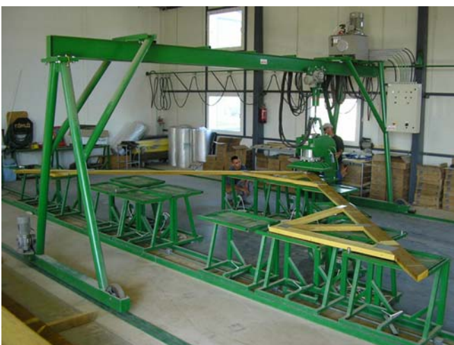
43. ábra Lekötött fedélszék préselése
