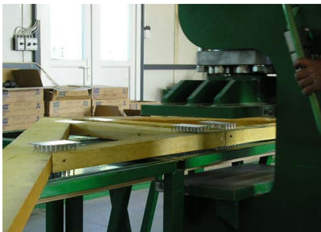
3. ábra Kétoldalt elhelyezett szeglemez a préselés előtt
