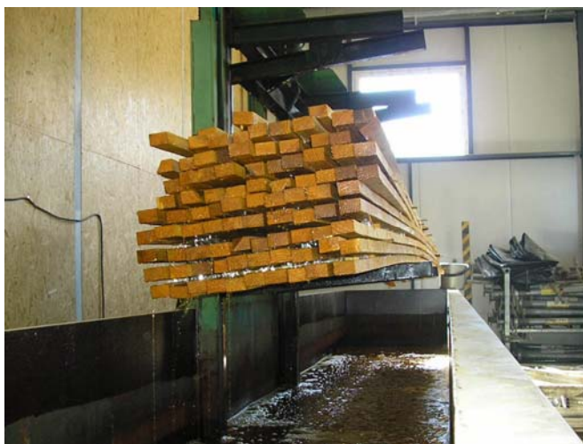
38. ábra Lécek a védőszeres áztatás után, az acélkádából kiemelve
