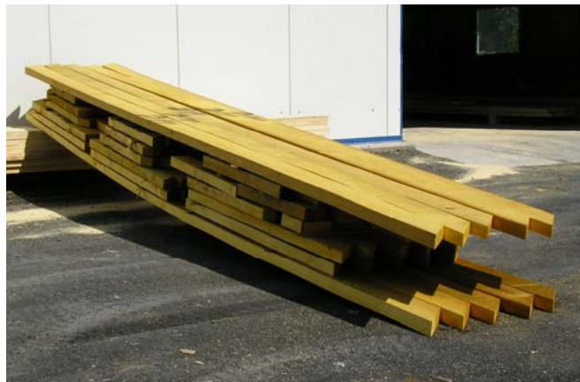
39. ábra Leszabott majd védőszerrel áztatott pallók légszárítása
