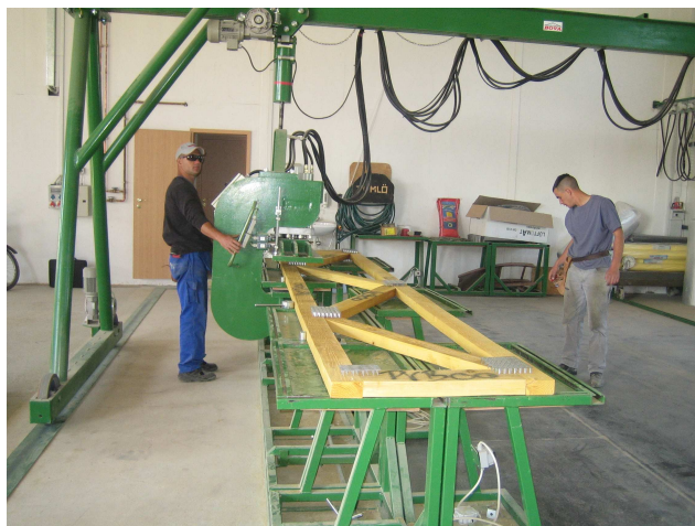
MiTek szeglemezes faszerkezet gyártása
